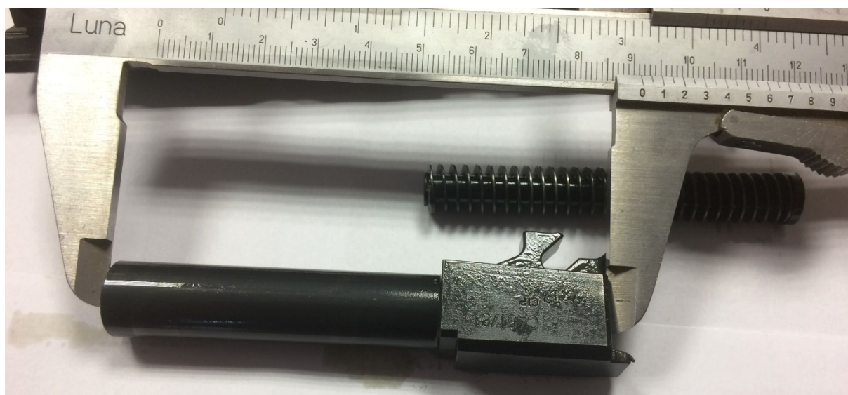
Rysunek 6 - Długość lufy wraz z komorą naboju – 91mm
